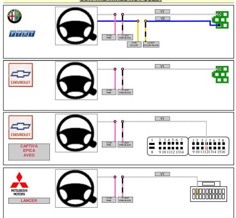
RADIO CONNECTORS ARE SEEN FROM THE WIRES BACK VIEW.
