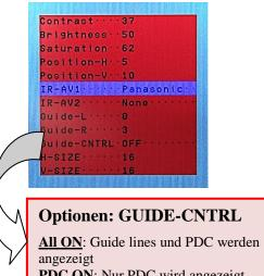
**<u>PDC ON</u>**: Nur PDC wird angezeigt. <u>**Guide ON**</u>: Nur Guide lines angezeigt. <u>**ALL Off**</u>: Guide lines und PDC werden nicht angezeigt.
